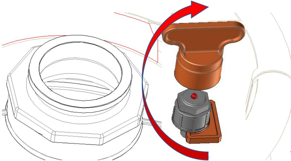
5/ Die Strebe entfernen, die neue schwarze Kappe auf Sicherheitsventil setzen und aufklippen
