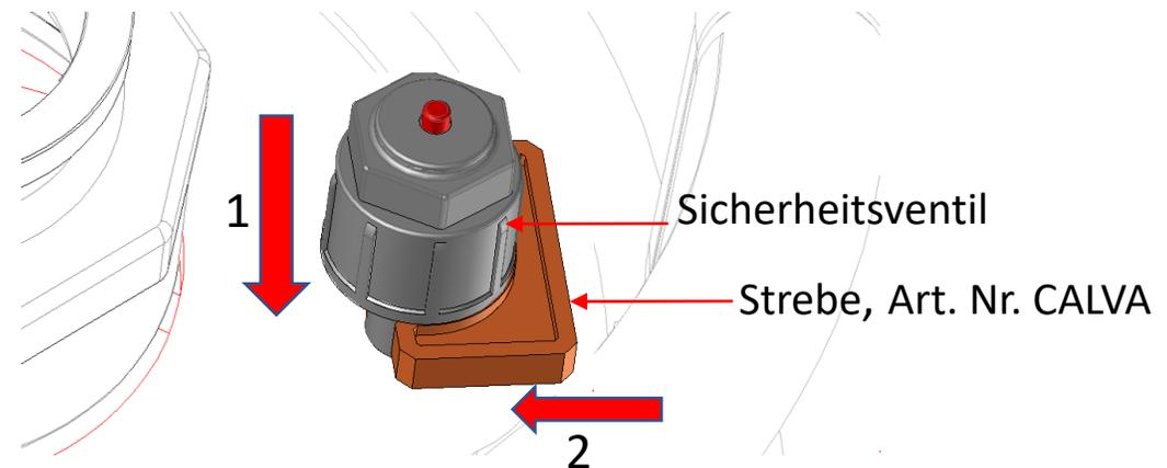
4/ Das Sicherheitsventil mit dem Schlüssel bis zum Anschlag mit der Strebe schrauben
