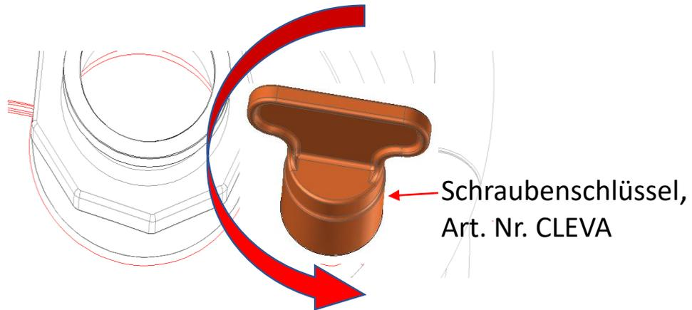
3/ Das neue Sicherheitsventil auf Gewindehals gerade einführen (1)
