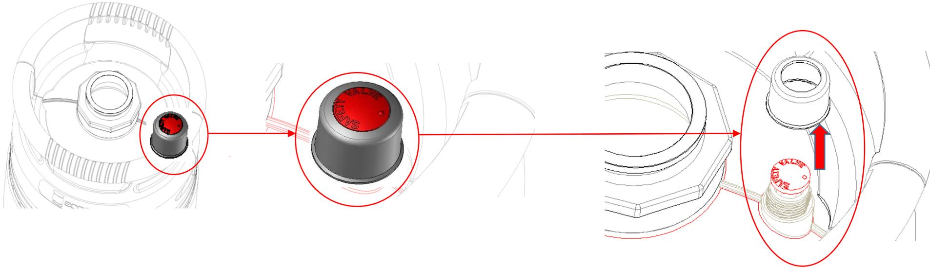
2/ Das Sicherheitsventil mit Schlüssel abschrauben
